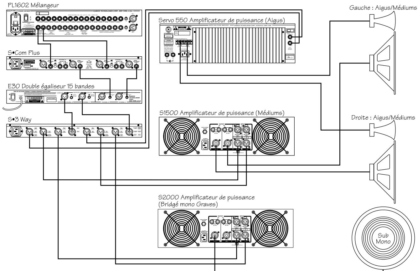
Dans cet exemple, le S•com Plus est inséré après la console de mixage et avant l'égaliseur graphique. Il compresse donc la totalité du signal provenant de la console.
