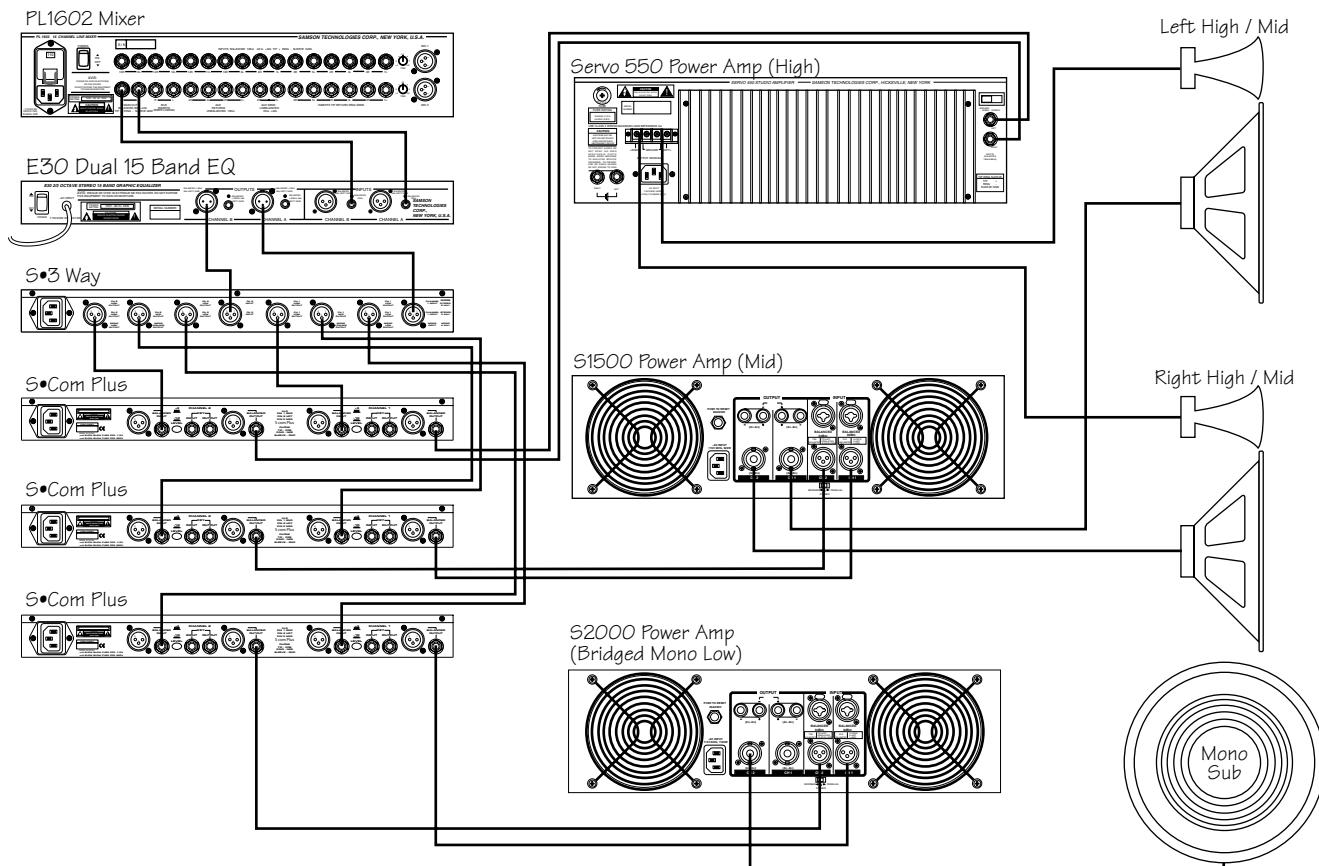
*Dans cet exemple, trois S•com Plus sont insérés après la console de mixage, l'égaliseur et le filtre actif, ce qui permet une compression individuelle des graves, médiums et des aigus.*
