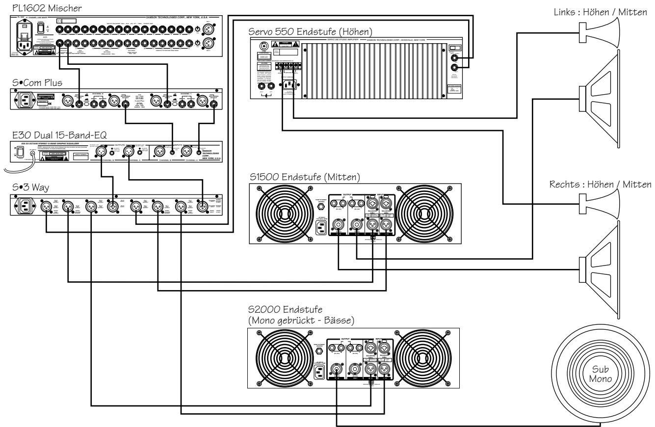
In diesem Beispiel ist der S•com plus hinter den Mischer und vor den grafischen EQ geschaltet und komprimiert dadurch das breitbandige Signal des Mixers.
