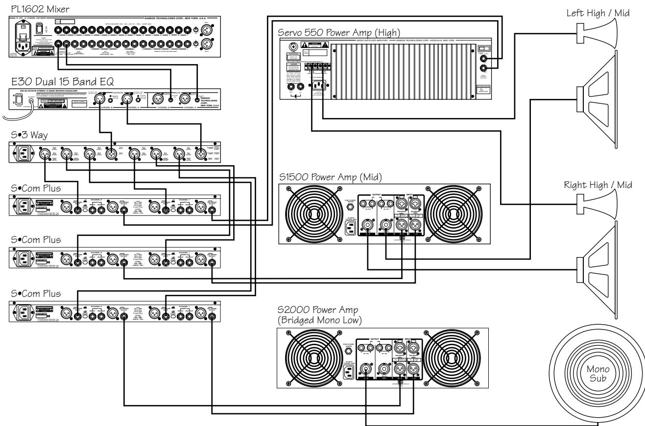
In diesem Beispiel werden drei S•com plus hinter Mischer, EQ und Crossover geschaltet und ermöglichen so eine individuelle Kompression der Bässe, Mitten und Höhen.
