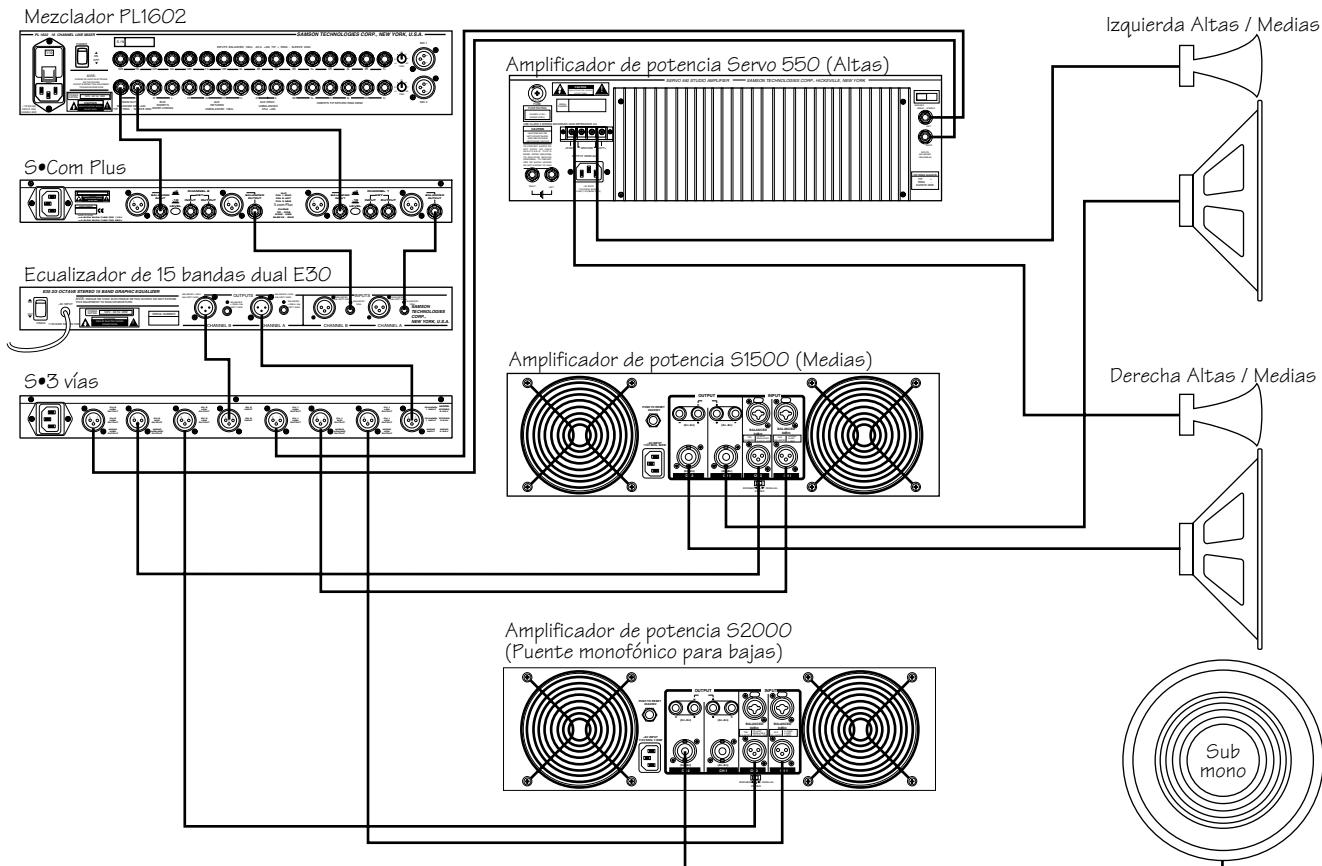
En este ejemplo, el S•com plus se ha insertado después del mezclador y antes del ecualizador gráfico, con lo cual se comprime toda la gama de la señal procedente del mezclador.
