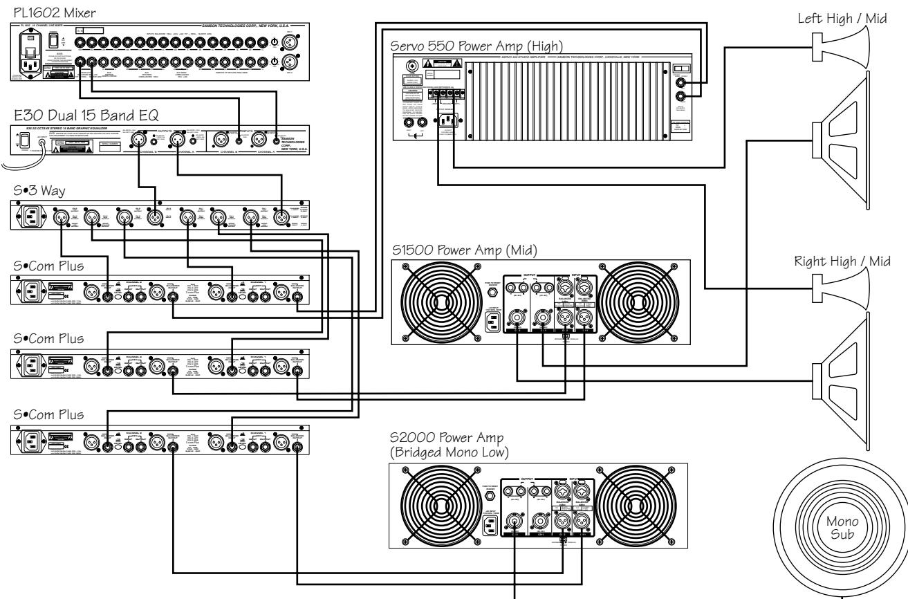
En este ejemplo se han insertado tres S•com plus después del mezclador, ecualizador y la transmisión, con lo cual pueden comprimirse de manera individual las frecuencias bajas, medias y altas.
